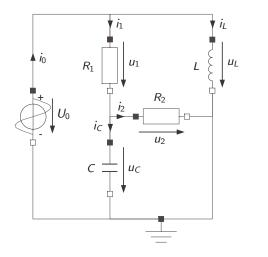
$u_{1} = R_{1} \cdot i_{1}$   $u_{2} = R_{2} \cdot i_{2}$   $u_{L} = L \cdot di_{L}$   $i_{C} = C \cdot du_{C}$   $u_{0} = u_{1} + u_{C}$   $u_{L} = u_{1} + u_{2}$   $u_{C} = u_{2}$   $i_{0} = i_{1} + i_{L}$   $i_{1} = i_{2} + i_{C}$   $i_{L} = \operatorname{pre}(i_{L}) + \overline{h} \cdot di_{L}$   $u_{C} = \operatorname{pre}(u_{C}) + \overline{h} \cdot du_{C}$
