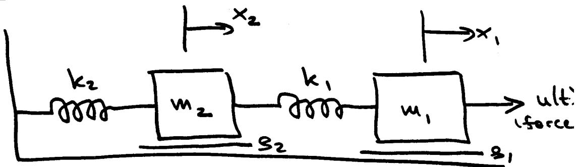
$$\Rightarrow \begin{cases} m_1 \ddot{x}_1 + g_1 \dot{x}_1 + k_1(x_1 - x_2) = u(t) \\ m_2 \ddot{x}_2 + g_2 \dot{x}_2 - k_1(x_1 - x_2) + k_2 x_2 = \phi \\ y_1 = x_1 \\ y_2 = \dot{x}_1 \end{cases}$$
